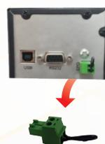
Le bouton d'arrêt d'urgence (EPO), également appelé commutateur EPO ou panneau EPO, constitue une mesure de sécurité permettant de déconnecter rapidement l'alimentation électrique d'un équipement particulier ou de toute une installation en cas d'urgence.
